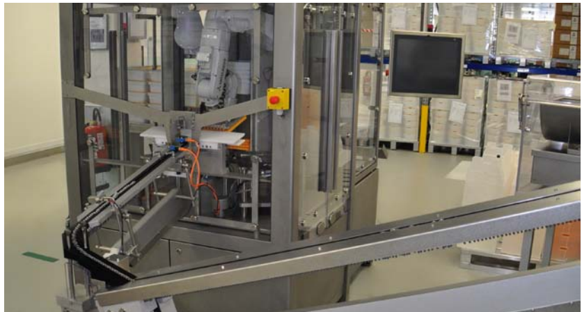
Bei Abmaßen von 1,0 mal 1,3 Meter ist der Platzbedarf des MRT-Basic-Moduls nicht größer als der einer Europalette bei einer Höhe von 2,20 Meter.
